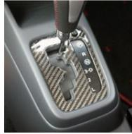
ゲートATの操作パネルを飾るカーボン製カバーです。カーボン風シートではなくリアルカーボンに拘って制作しました。取付けはコンソールの間に挟み込み両面テープで張り付けします。(貼付けの際には折れたり変形しない様にご注意下さい。)
