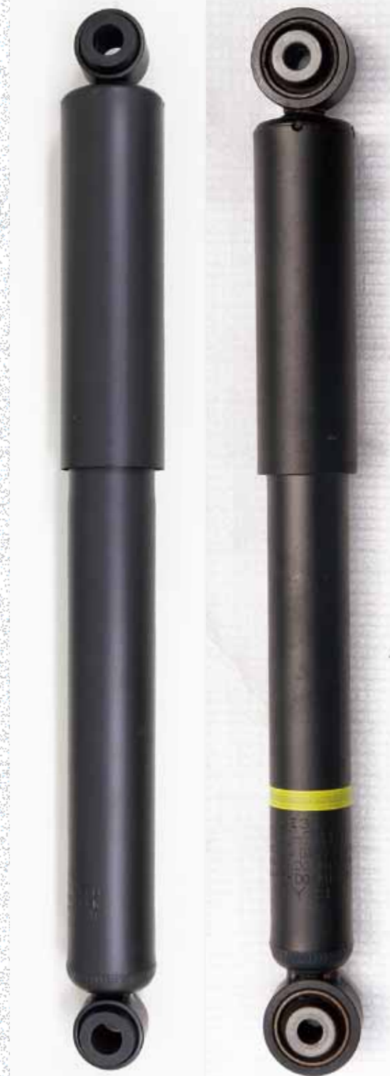
ダンパーの太さほとんど同じだけど、減衰力はかなり異なります。また見た目の通りアイ部分はJB64の方がひと回り以上大きくなっています。
