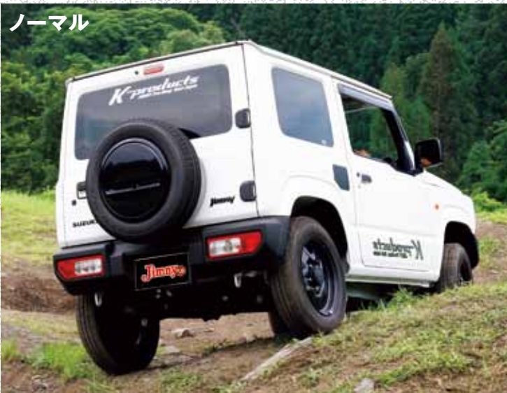
この状態で右後輪がスリップ。前輪のトラクションが弱くて進めない。純正タイヤだが...
